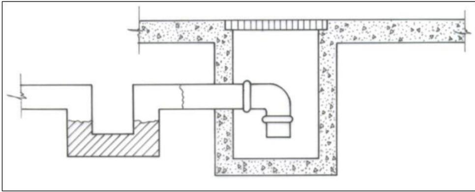
Figura 4.24: Detalhes de purgador selado por líquido.
