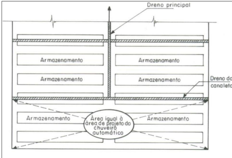
Figura 4.21: Vista em planta de controle de líquidos em armazéns.
