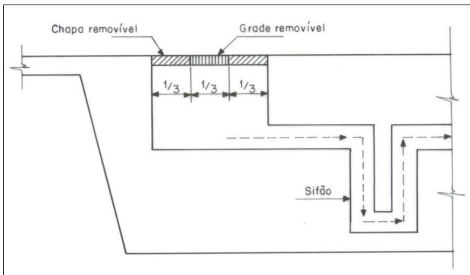
Figura 4.22: Detalhes do projeto de drenagem de canaletas.
