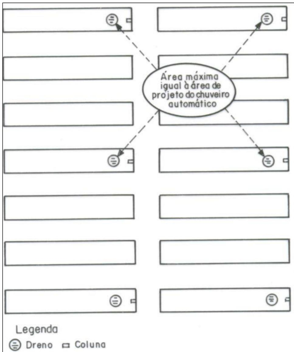
Figura 4.23: Arranjo típico de drenos de piso.
