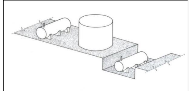
**Figura 1.1:** Tanques de superfície instalados acima do piso, no piso e abaixo do piso sem aterro
